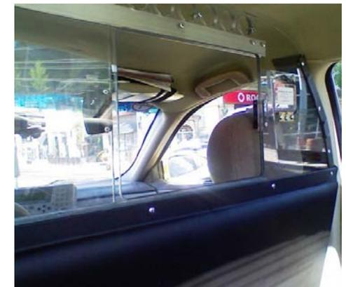
**Cloison : vitre protectrice permettant de séparer les occupants de la banquette arrière de ceux de la banquette avant**
