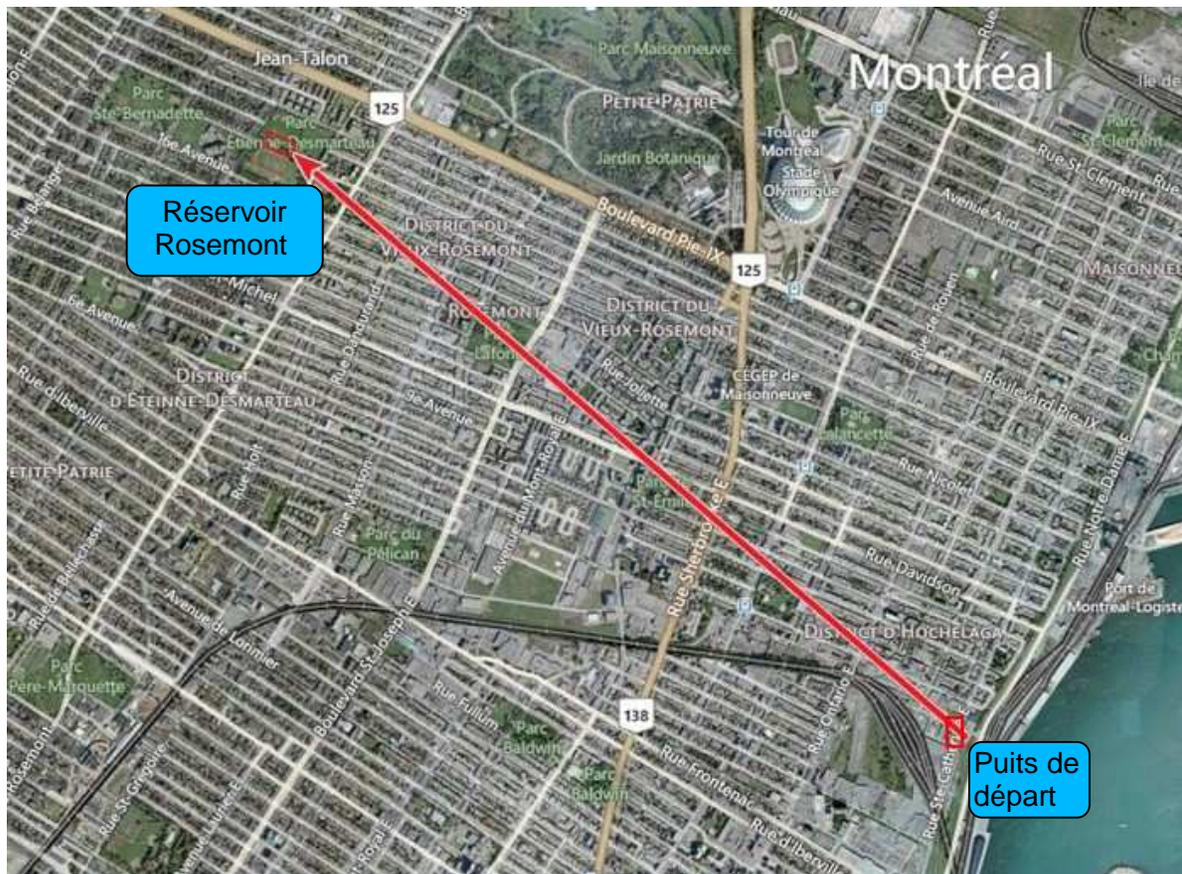
Conduite de **4,025 km** en tunnel pour permettre le remplissage du réservoir
