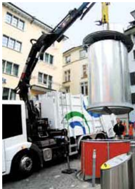
Collecte mécanisée d'un bac de collecte enterré en centre ville de Zurich
