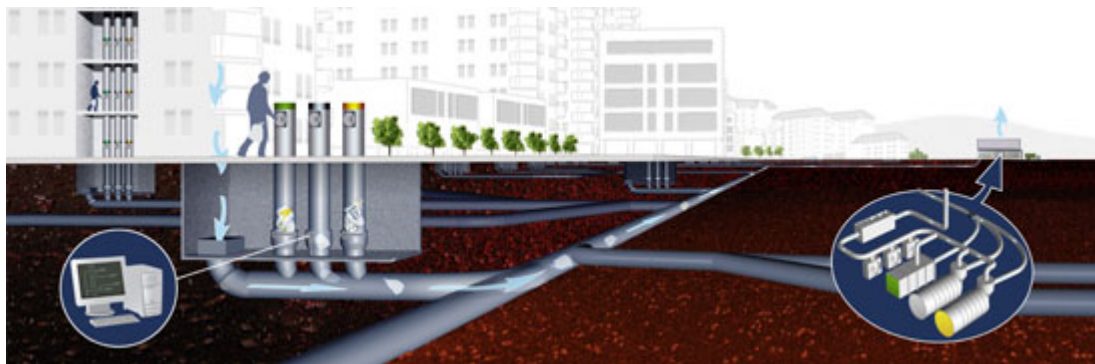
Figure 5-1 : Schéma descriptif du système de collecte stationnaire automatisé ENVAC®
