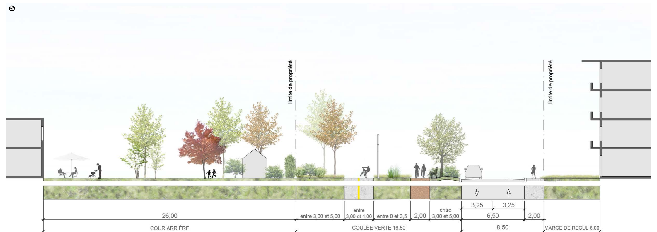
Fig. 96. Coupe type d'une piste multifonctionnelle
