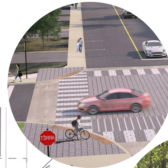
TROTTOIR EN PAVÉS DE BÉTON, BORDURE EN GRANITE, PLAQUES PODOTACTILES
