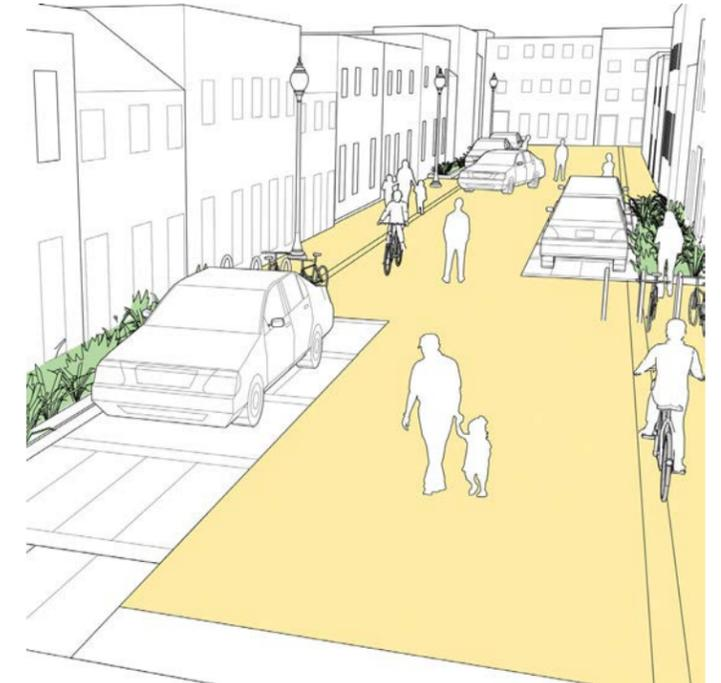
Fig. 102. Axonométrie schématique d'une rue partagée résidentielle
