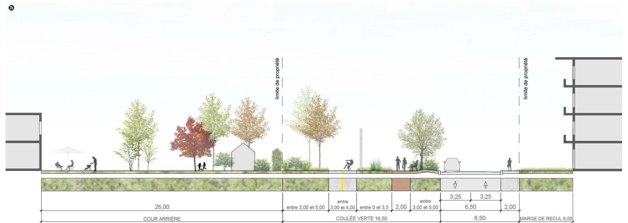
Fig. 96. Coupe type d'une piste multifonctionnelle
