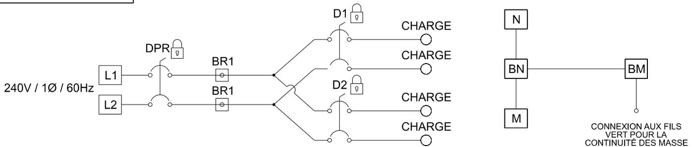
**SCHÉMA ÉLECTRIQUE****CARACTÉRISTIQUE DU COFFRET:**
