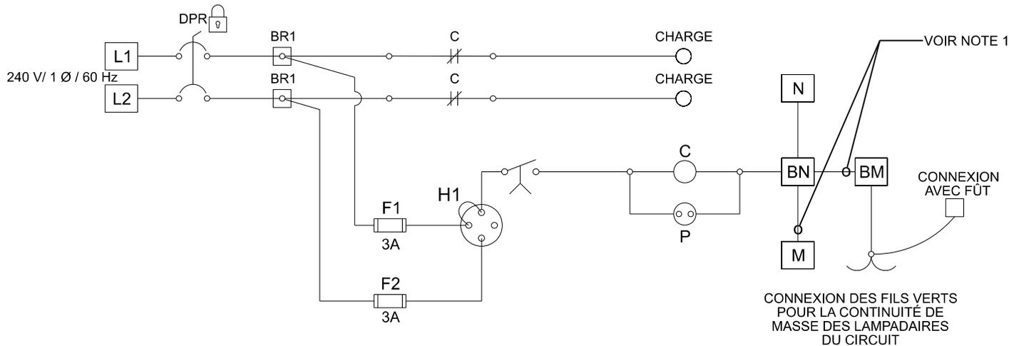
**SCHÉMA ÉLECTRIQUE****CARACTÉRISTIQUE DU COFFRET:**
