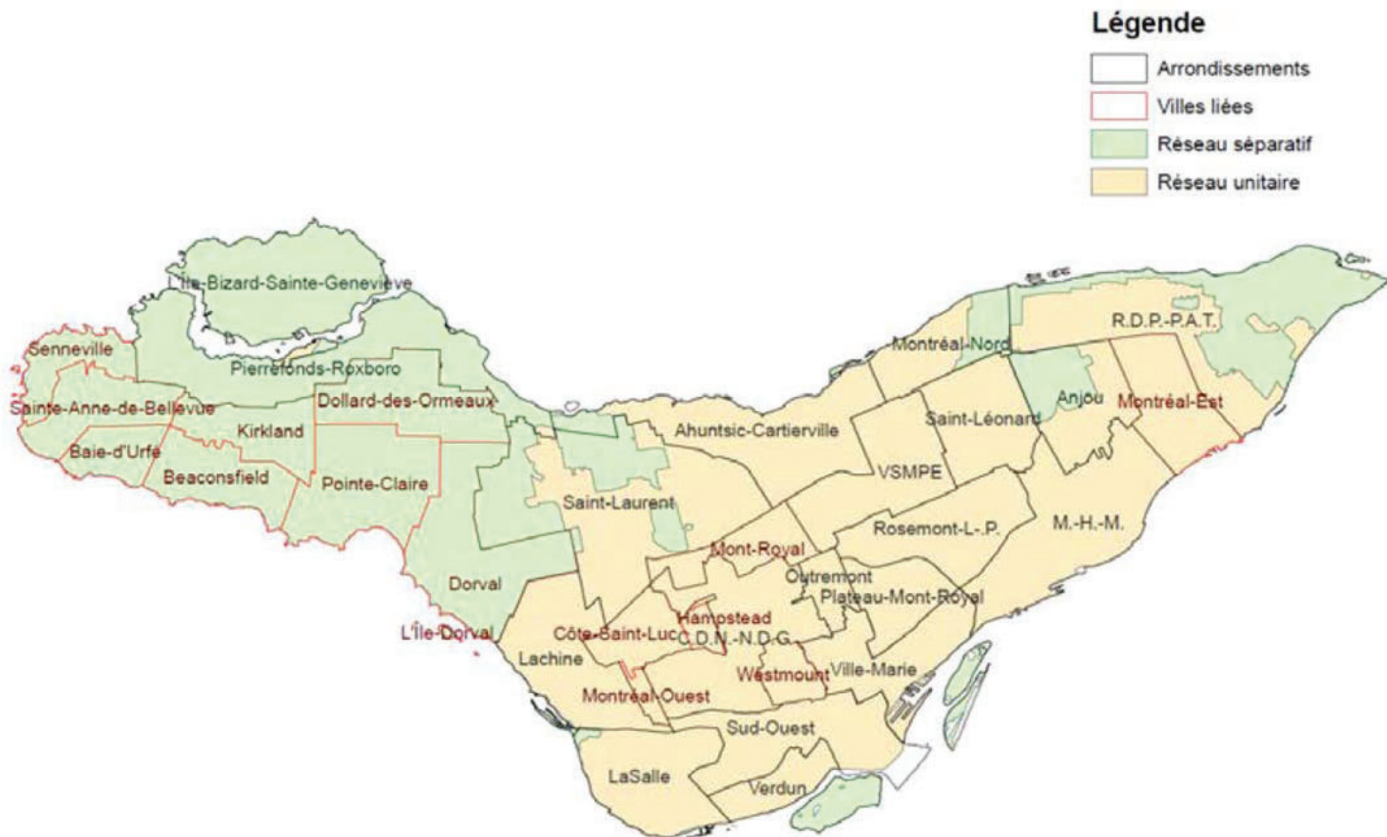
FIGURE 8 : Répartition des réseaux de drainage
