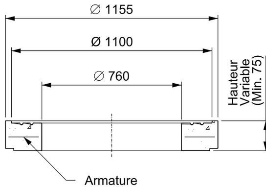
**Anneau d'ajustement en béton**
