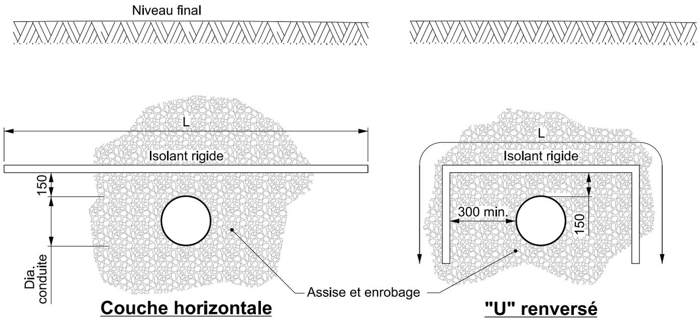
**L = LARGEUR DE L'ISOLANT (mm)**
