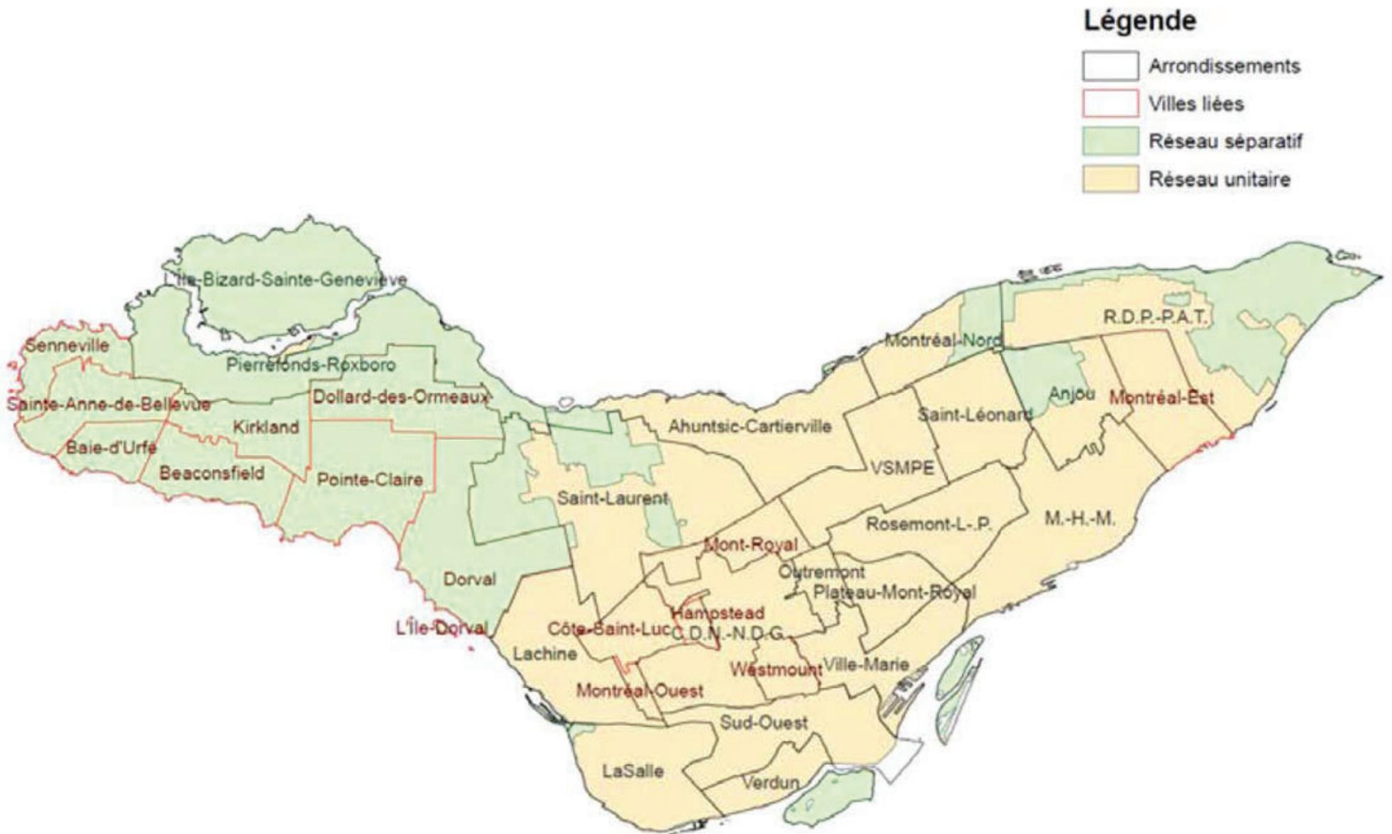
FIGURE 8 : Répartition des réseaux de drainage
