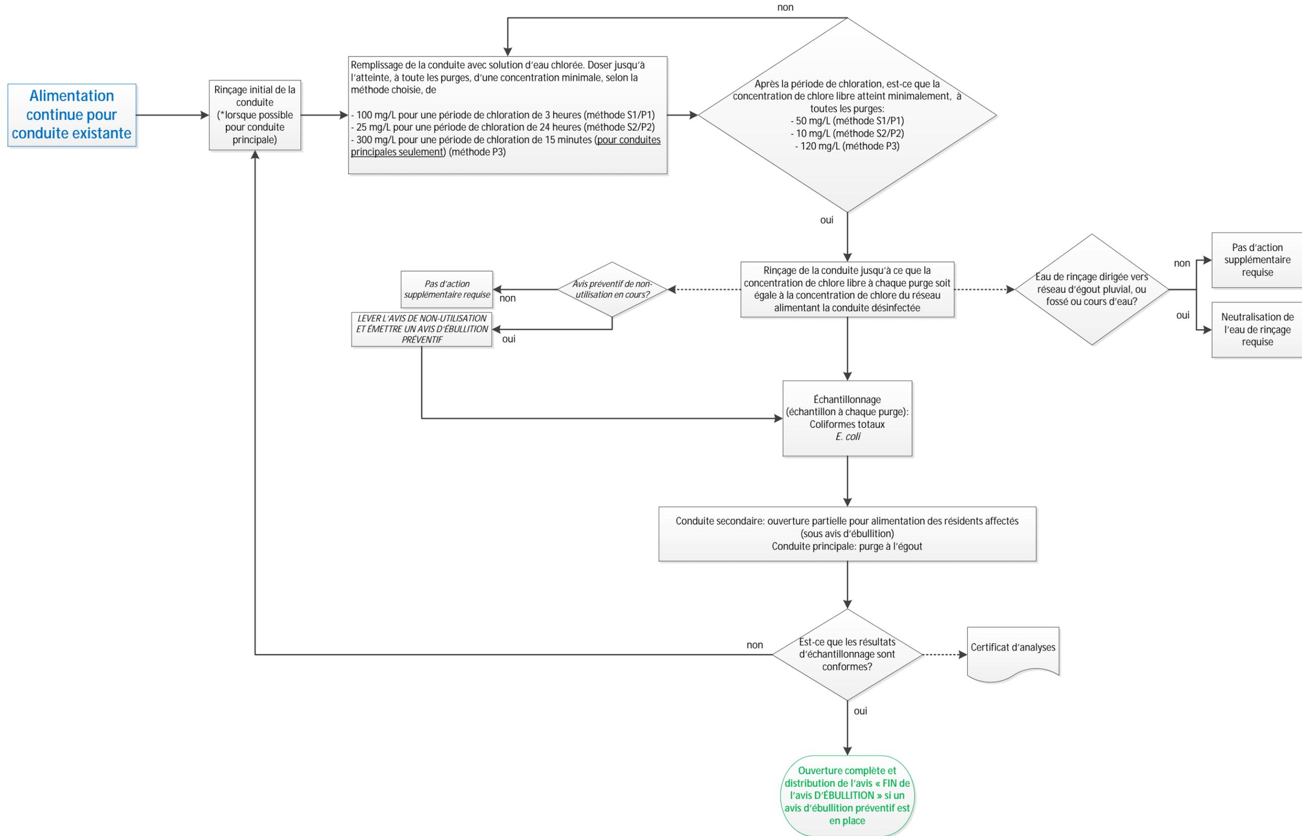
Désinfection d'une nouvelle conduite, d'une conduite réhabilitée ou d'un réseau temporaire
