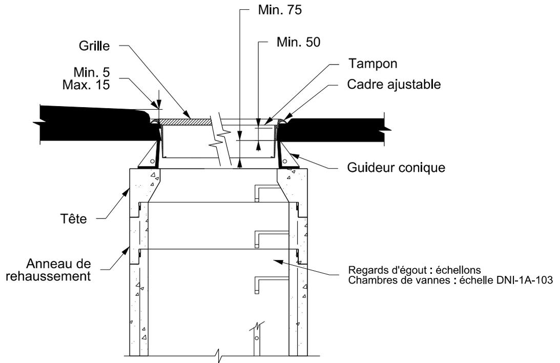
**Ajustement des cadres dans les chaussées mixtes ou souples**
