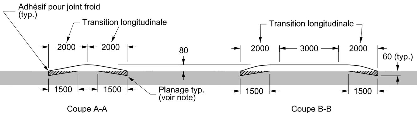
**Évolution sinusoïdale de la transition longitudinale sur une longueur de 2 m**
