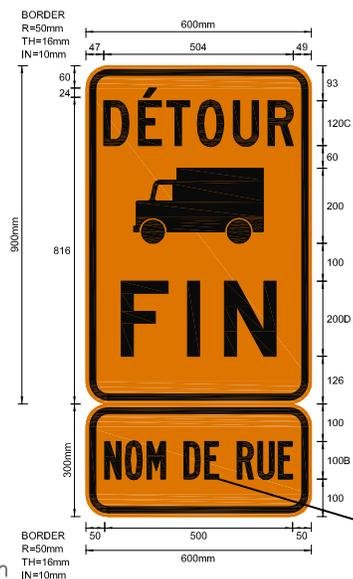
AJUSTER «NOM DE RUE»: HIGHWAY GOTHIC, SÉRIE B. HAUTEUR DE 100mm CENTRÉ LONG. MAX 500mm
