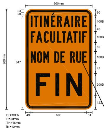
AJUSTER «NOM DE RUE»: HIGHWAY GOTHIC, SÉRIE B, HAUTEUR DE 100mm CENTRÉ LONG. MAX 500mm
