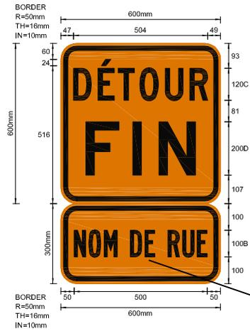
AJUSTER «NOM DE RUE»: HIGHWAY GOTHIC, SÉRIE B, HAUTEUR DE 100mm CENTRÉ LONG. MAX 500mm
