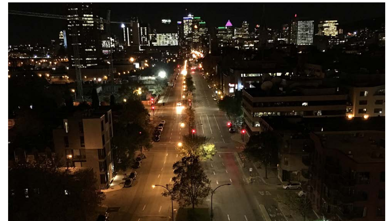
CÔTÉ GAUCHE : LUMINAIRES NON CONVERTIS, BOULE LUMINEUSE VISIBLE DU CIEL CÔTÉ DROIT : LUMINAIRES CONVERTIS À DEL DE TYPE CIEL NOIR
