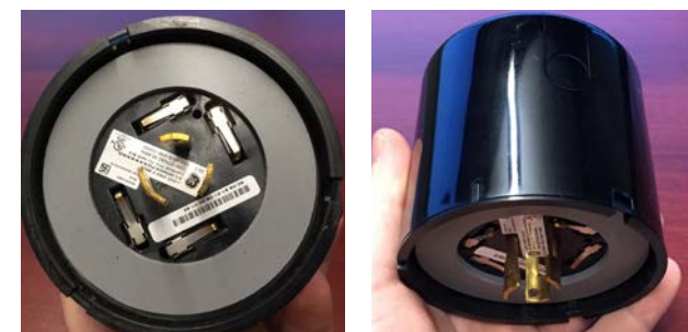
EXEMPLE D'UN NŒUD INTELLIGENT EXTERNE POUR LE LUMINAIRE COBRA À DEL
