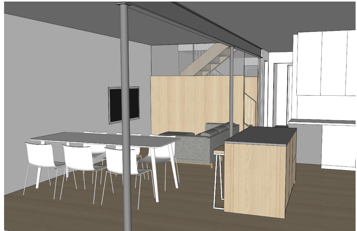
RDC : NOUVELLE STRUCTURE D'ACIER ET ILOT DE CUISINE
