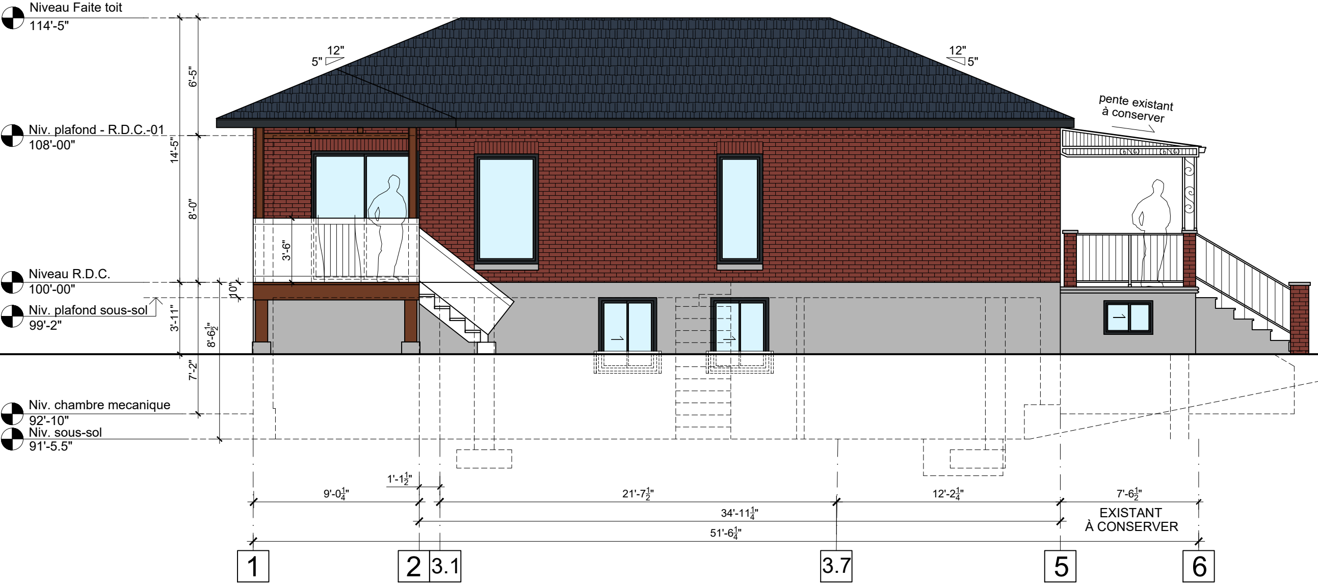
ÉLEVATION LATÉRALE GAUCHE COULEUR - AMENAGEMENT ECHELLE: 3/16"=1'-0"
