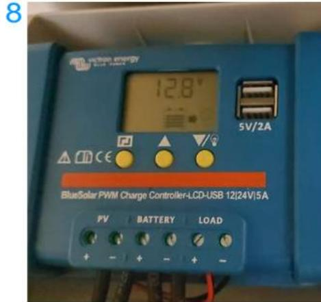
Le contrôleur doit s'allumer normalement. L'affichage doit correspondre à la photo ci-dessus. (la tension peut varier)
