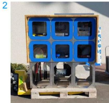
Retirez les plaques avant et arrière de la station en enlevant les 16 vis à la main. Mettez les plaques de côté temporairement.
