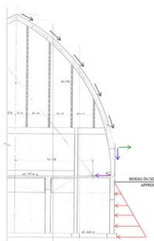
Figure 11. Coupe partielle du voile
