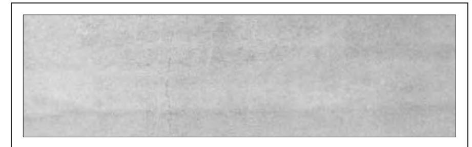
CRÉPI DE CIMENT (GRIS 'BÉTON') *fini de murs de fondation exposés
