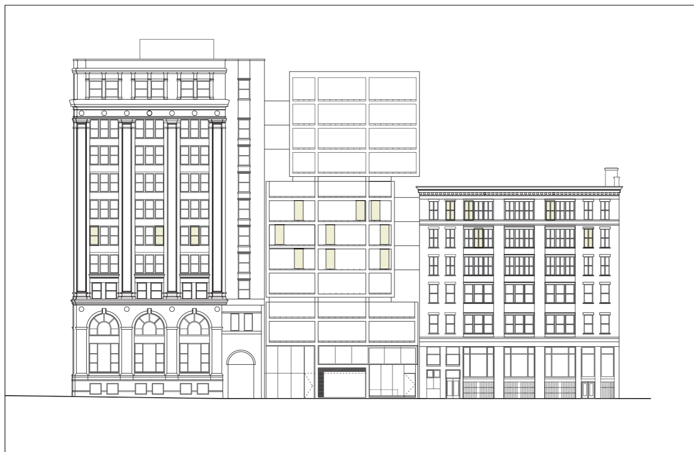
L'OUVRANT S'INSÈRE DANS LA LARGE BAIE VITRÉE DE L'UNITÉ. SON ARTICULATION RAPPELLE LA PROPORTION DES FENETRES ADJACENTES.
