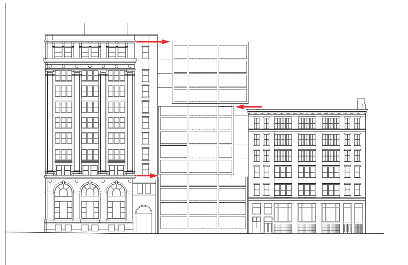
LA FAÇADE DE PIERRE CALCAIRE SE MODULE EN FONCTION DES ÉLÉMENTS ARCHITURAUX MAJEURS DES BÂTIMENTS VOISINS.
