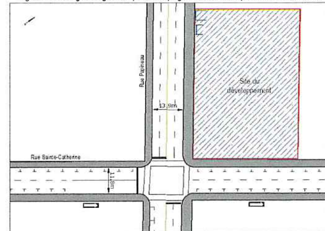
Figure 2 - Aménagement géométrique et marquage - Intersection Papineau/Sainte-Catherine
