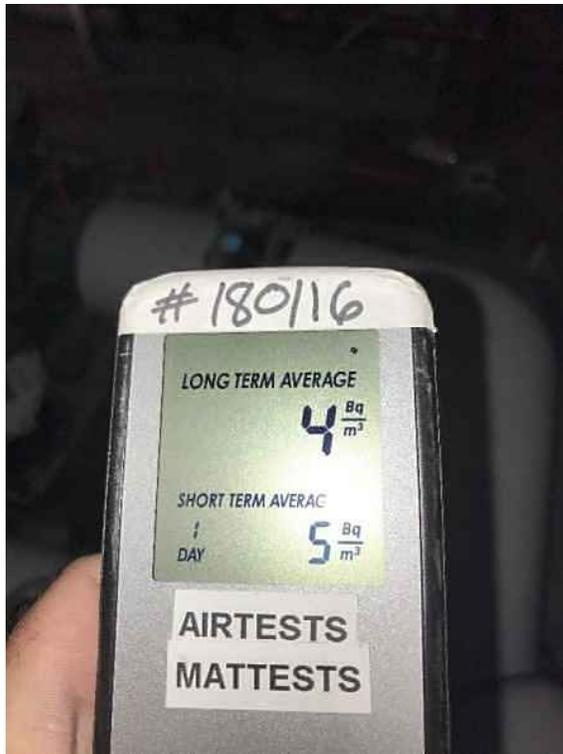
NIVEAUX DE RADON DANS L'AIR EXTÉRIEUR – 11<sup>E</sup> ÉTAGE
