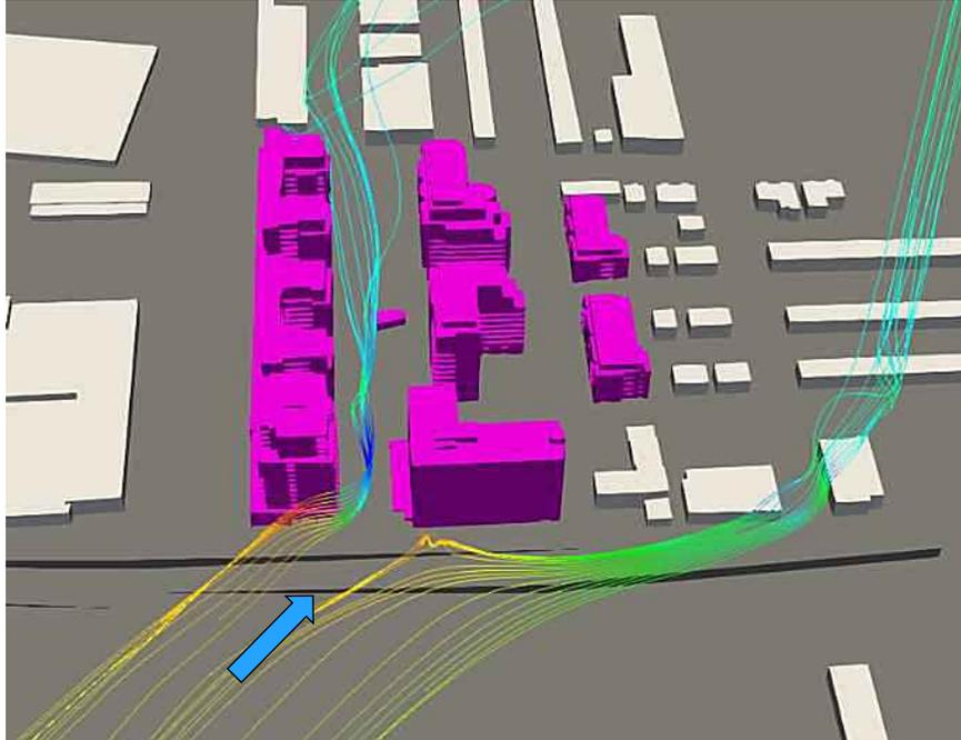
**Photo 4 Écoulement dans le prolongement de l'avenue de-Courtrai (vent du OSO - Variante 12415 à 16 étages)**
