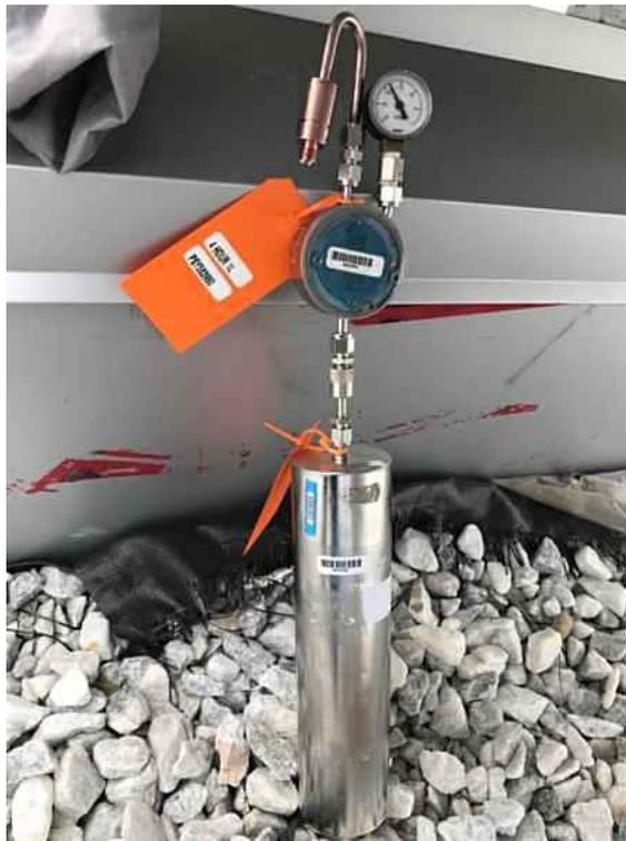
PRÉLÈVEMENT D'AIR EXTÉRIEUR – POUR LES COV – 11<sup>E</sup> ÉTAGE
