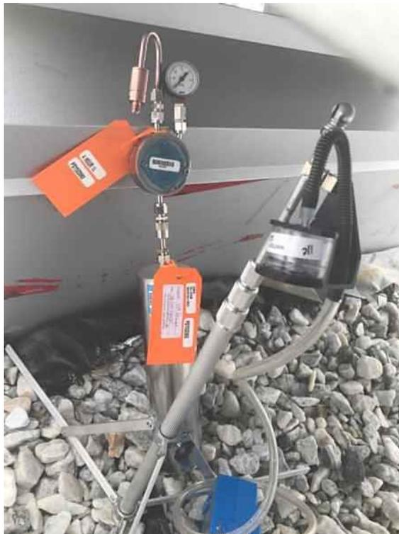
*PRÉLÈVEMENT D'AIR EXTÉRIEUR – 11<sup>E</sup> ÉTAGE – COV ET PLOMB*
