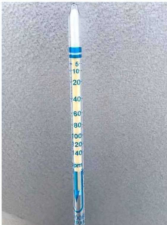
NIVEAUX DE ACÉTALDÉHYDE VIA TUBE COLORIMÉTRIQUE EXTÉRIEUR – 11<sup>E</sup> ÉTAGE
