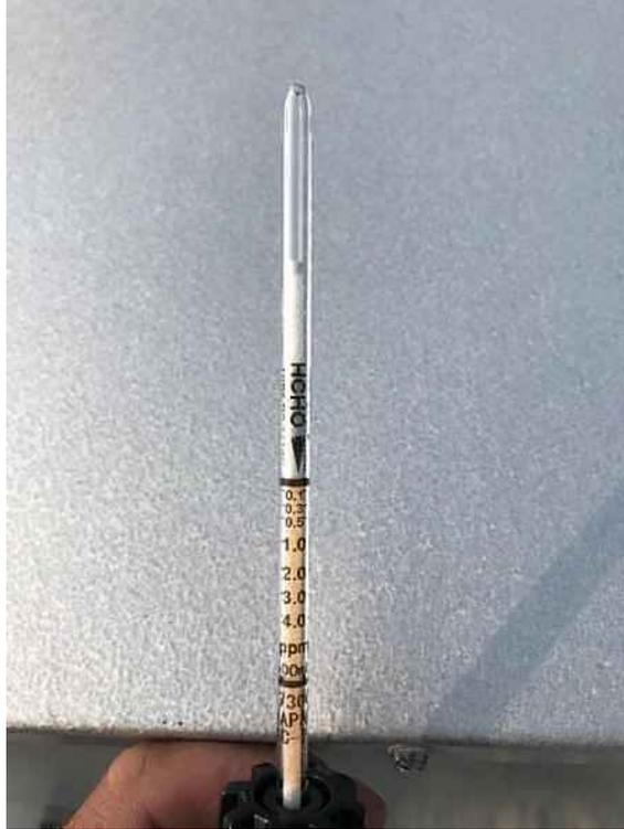
*NIVEAUX DE FORMALDÉHYDE VIA TUBE COLORIMÉTRIQUE EXTÉRIEUR – 11<sup>E</sup> ÉTAGE*
