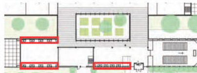
Réutilisation des armoires de bois existantes dans la fenestration et les murs des salles communes de la nouvelle résidence
