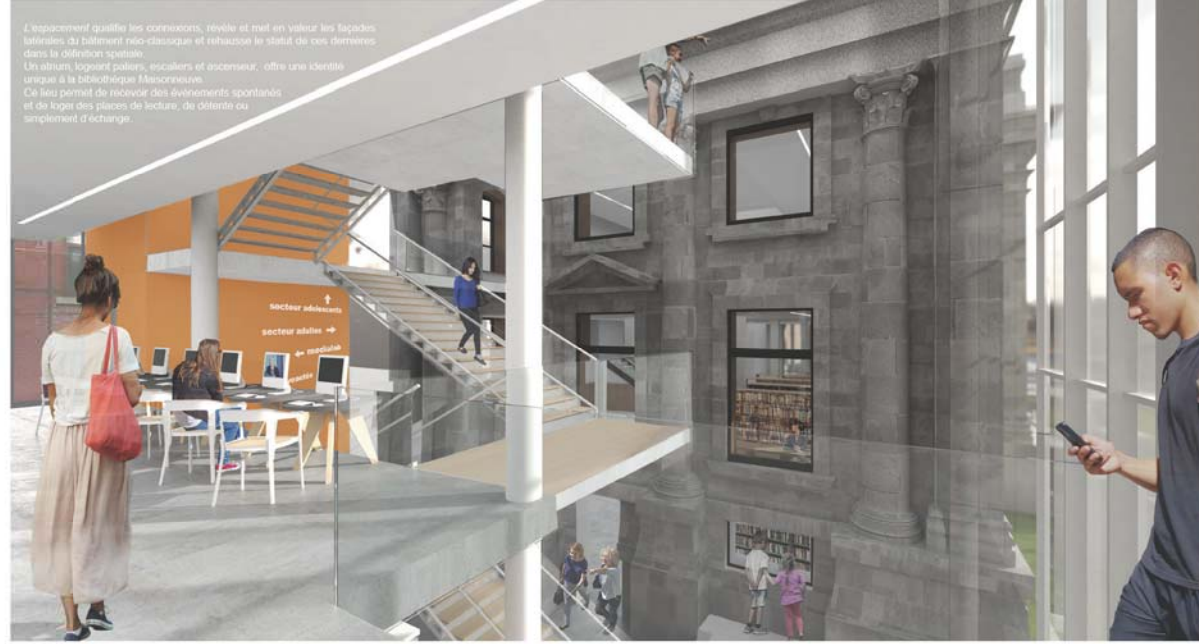
Une enveloppe à respiration contrôlée, orientée au sud, permet la récupération de l'énergie solaire en hiver, une protection à l'été et à la surchauffe en été. Une double paroi de verre intègre des composants de protection solaire, panneaux photovoltaïques et ventilation hybride. Un jardin intérieur accessible habite cet espace.
