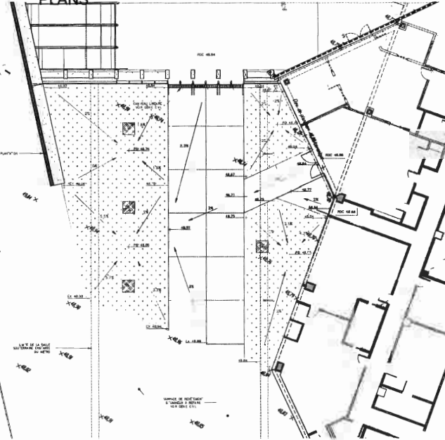
NIVELLEMENT ET DRAINAGE - ARRIÈRE 06 ÉCHELLE: 1:100
