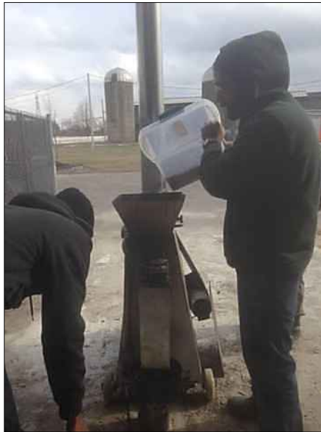
Fig. 2. Pyrolyse des copeaux de bois de frêne dans un pyrolyseur à échelle de laboratoire.
