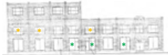
[68] L'élévation sur le boulevard Saint-Laurent telle que proposée dans une demande de permis de 1977; si on la compare avec l'élévation existante [59], on voit les trois nouvelles alcôves avec les quatre nouvelles portes d'entrée (\*), les nouvelles vitrines commerciales et les trois fenêtres ajoutées au 2<sup>e</sup> étage (\*) (Permis n° 3957, 1977, AVSMPE)
