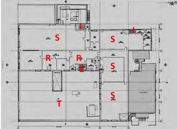
[188] Le plan existant du 3<sup>e</sup> étage, montrant le toit du 2<sup>e</sup> étage (T), avec son puits de lumière et ses appareils mécaniques, ainsi que les différentes salles de danse (S), l'aire de réception et des bureaux (R), l'escalier principal entre les 2<sup>e</sup> et 3<sup>e</sup> étages (E) et les deux escaliers d'issue (I) (KANVA, 23 février 2021)
