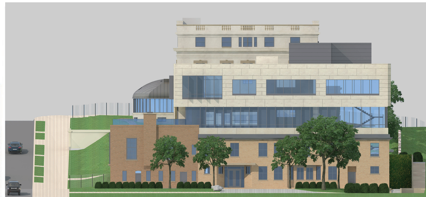
Élévation de l'annexe montrant le bâtiment existant conservé, les ouvertures modifiées et l'ajout de 2 étages au-dessus (voir aussi A301 & D301)
