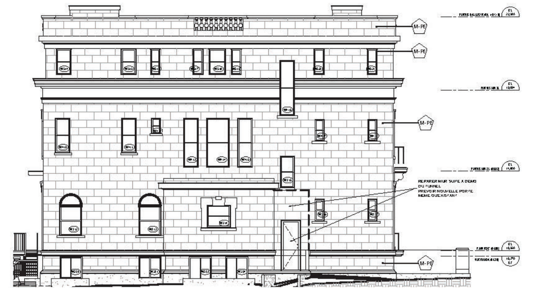
Élévation Est suite à la démolition prévue du Tunnel. Le mur de pierre de la façade sera réparé & restauré, la porte sera remplacée par une nouvelle porte tel que celle d'origine.
