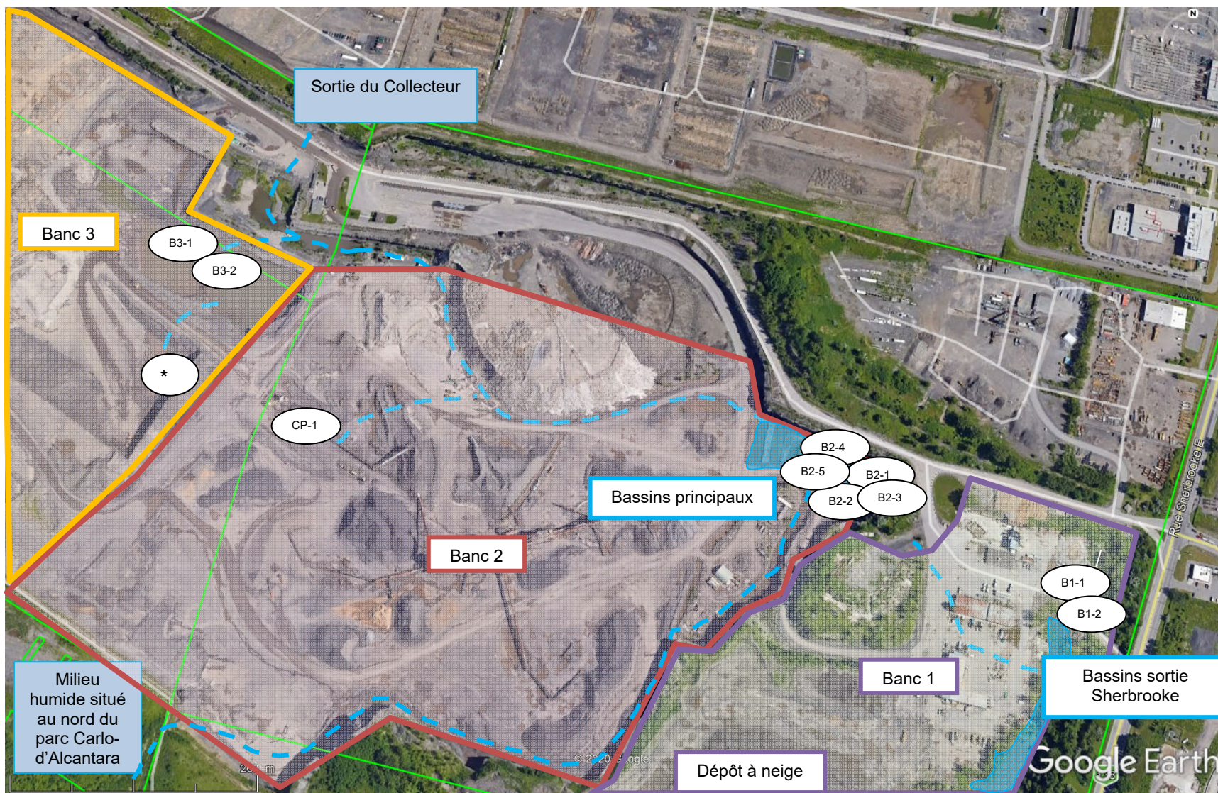
Figure 2 : Emplacement des pompes et trajet parcouru par l'eau de ruissellement dans la Carrière
