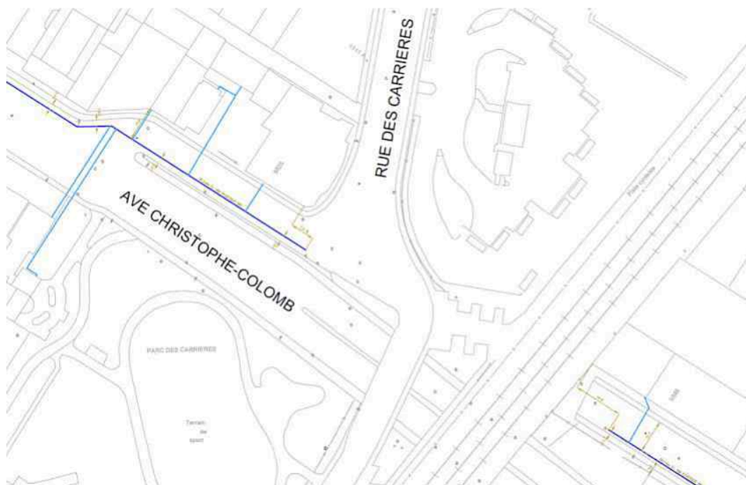
Figure 63 : Vue en plan – Info Excavation 2017 – Conduite Énergir
