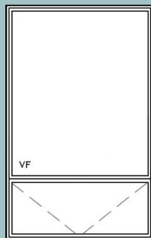
Fenêtre avec verre FIXE et section à auvent
