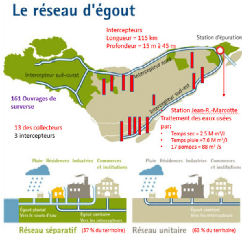
FIGURE 1 | SCHÉMA DU RÉSEAU D'ÉGOUT DE L'AGGLOMÉRATION DE MONTRÉAL
