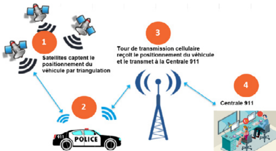
FIGURE 2 FONCTIONNEMENT D'UN SYSTÈME DE LOCALISATION PAR SATELLITE GPS
