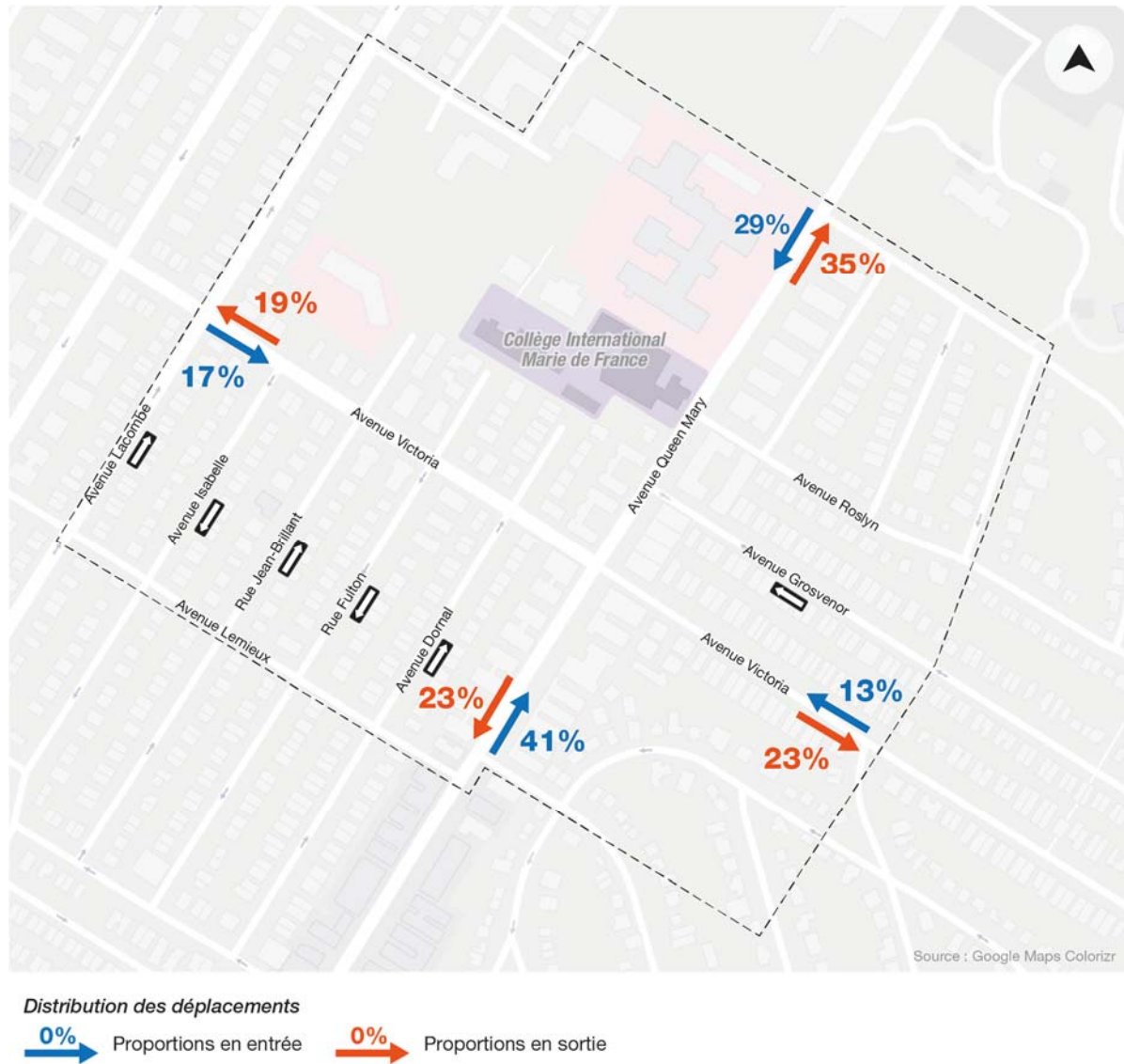
Figure 4.1 : Distribution en fonction des débits actuels entrants et sortants du secteur, heure de pointe AM
