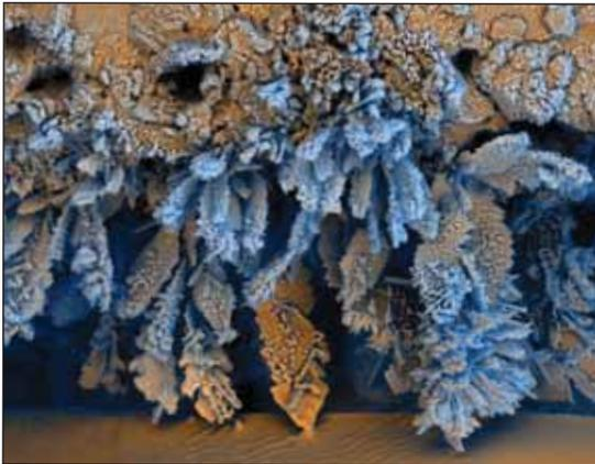
Vue au microscope de particules d'oxyde de fer
