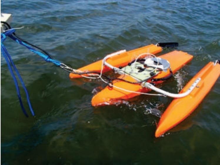
**Figure 15 : Équipement de prise de mesures (ADCP et radeau)**
