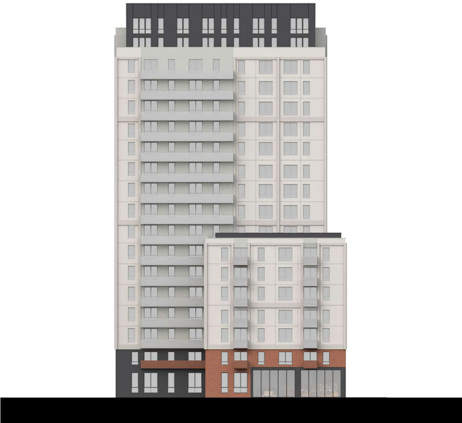
70% min du mur est recouvert de brique ou de panneau de béton préfabriqué.
