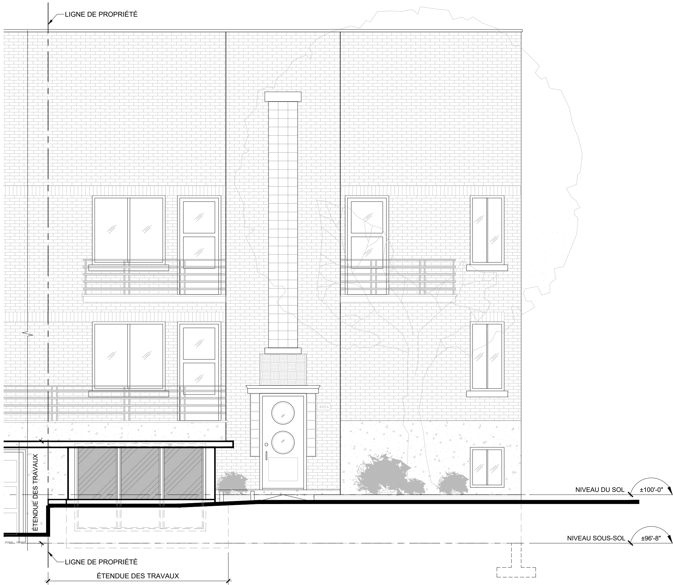
E1 ÉLÉVATION PROPOSÉE A-2.0 A-2.1 ÉCHELLE: 1/4" = 1' - 0"
