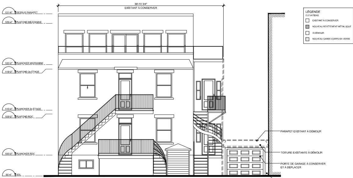
01 EXISTANT-DÉMOLITION ÉLEVATION AVANT A200 ÉCHELLE: 1/4" = 1'-0"
