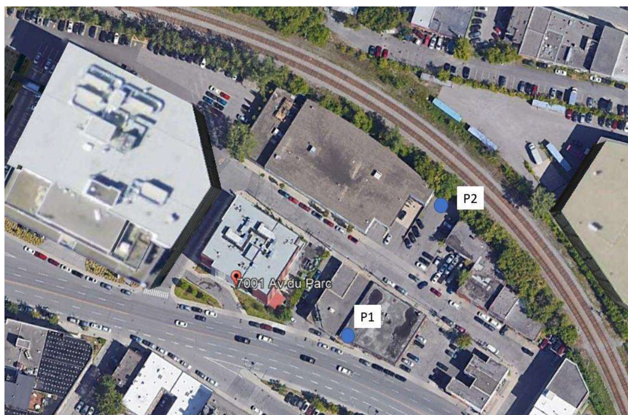
Figure 3 : Localisation des points de mesures acoustiques 24h (en bleu)
