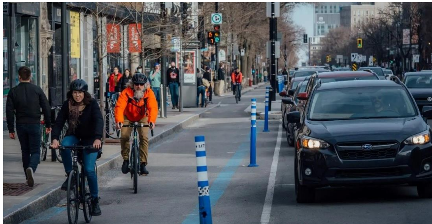
REV St-Denis, piste cyclable devant être traversée pour accéder à l'autobus, sans espace pour le déploiement de la rampe. Crédit : Le Devoir
