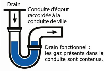
Les drains de plancher sont conçus pour maintenir une étanchéité dans la conduite afin d'empêcher tous les gaz et les odeurs présents dans celle-ci de pénétrer dans votre résidence.
