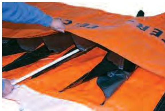
2 – À l'aide d'un bâton, s'assurer que toutes les cloisons sont défroissées pour obtenir un emballage compact et ainsi permettre à la barrière enroulée de mieux s'insérer dans son sac d'emballage.
