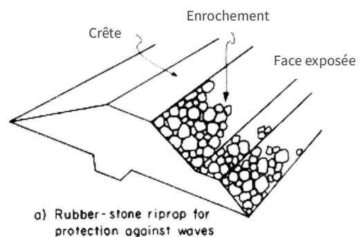
Figure 6 - Vue en coupe d'une digue type (FAO, 1983)
