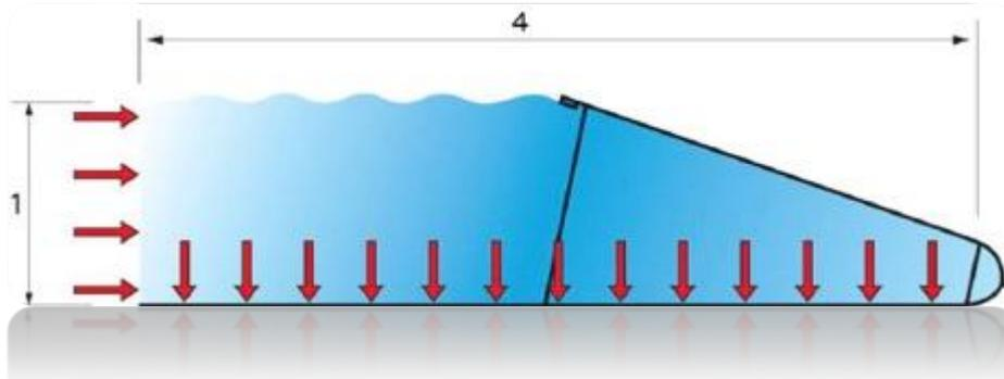
*Le Barrage Water-Gate anti inondation se déploie automatiquement avec le flux de l'inondation.*
