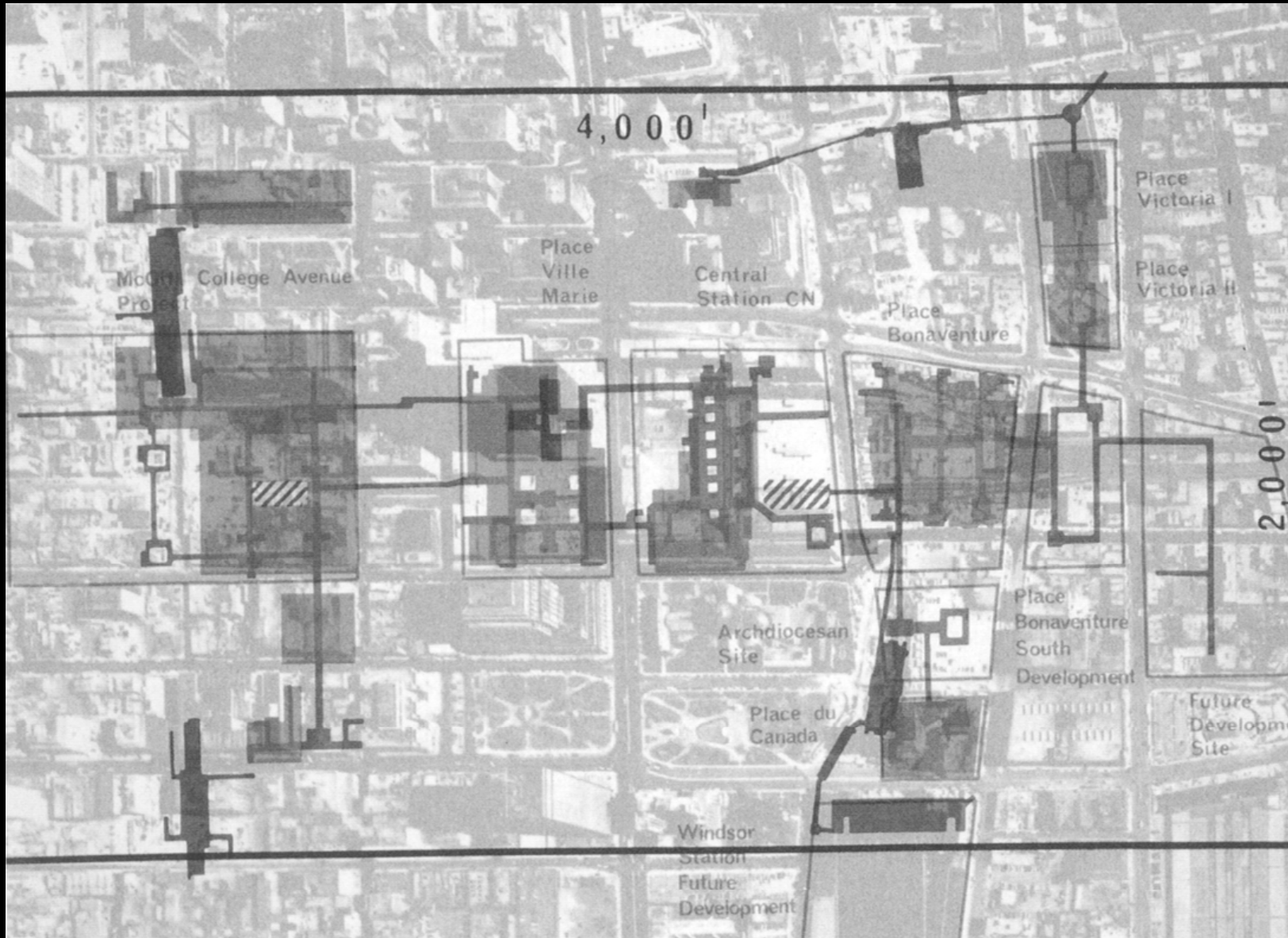
1969- Vincent Ponte, "Vue aérienne du centre-ville de Montréal avec surimpression d'un plan montrant le réseau piétonnier souterrain"
