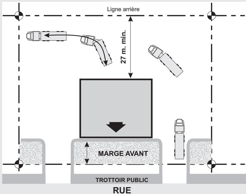
POUR UN QUAI DE CHARGEMENT LA LONGUEUR DU TABLIER DE MANOEUVRE EST DE 27 MÈTRE MINIMUM ET POUR UNE PORTE D'ACCÈS POUR CAMION CETTE DISTANCE PEUT ÊTRE RÉDUITE À 18 MÈTRE MINIMUM.
