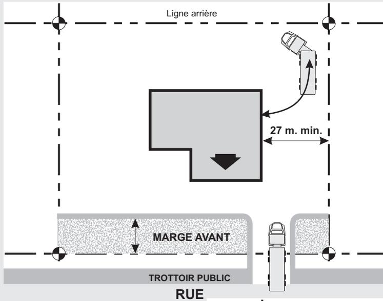
POUR UN QUAÏ DE CHARGEMENT LA LONGUEUR DU TABLIER DE MANOEUVRE EST DE 27 MÈTRE MINIMUM ET POUR UNE PORTE D'ACCÈS POUR CAMION CETTE DISTANCE PEUT ÊTRE RÉDUITE À 18 MÈTRE MINIMUM.
