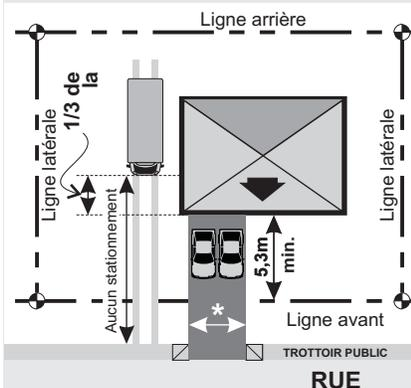
Dans le cas où une allée supplémentaire est nécessaire pour le stationnement d'un véhicule récréatif de plus de 23 m<sup>3</sup>, cette allée ne doit pas comporter de bateau de porte, ne doit pas être pavée sur toute sa largeur et doit comporter uniquement deux bandes de roulement de la largeur des roues du véhicule.
