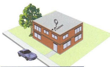
ANTENNE SUR TOIT PLAT
