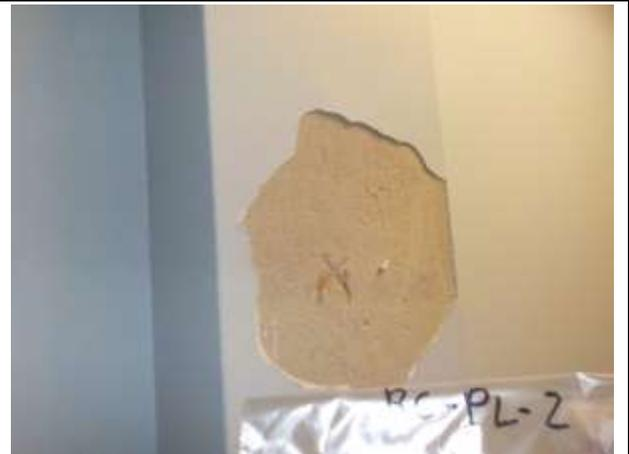
**RC-PL-2** : Rez-de-chaussée – mur de division – plâtre blanc et ciment brun
