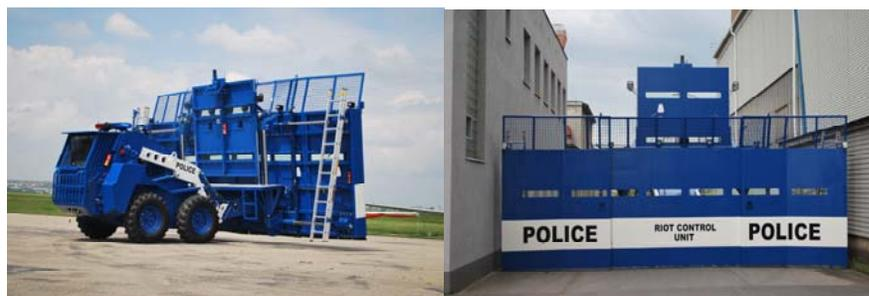
Figure 3 : Barrière mécanique BOZENA RIOT Control Unit
