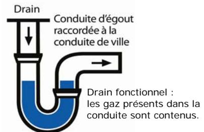
Les drains de plancher sont conçus pour maintenir une étanchéité dans la conduite afin d'empêcher tous les gaz et les odeurs présents dans celle-ci de pénétrer dans votre résidence.
