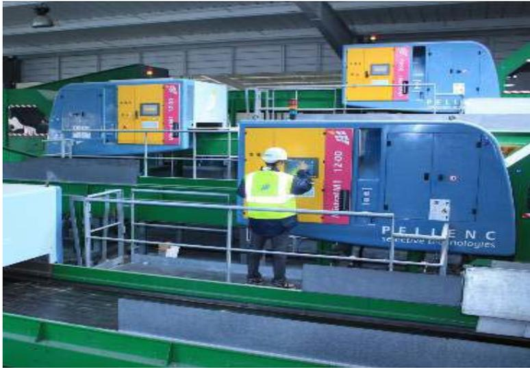
Système de tri-optique permettant de trier l'ensemble des matières recyclables dont la pellicule de plastique.
