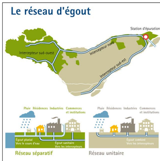
Figure 2. Schématisation du réseau d'égout de la Ville de Montréal 6
