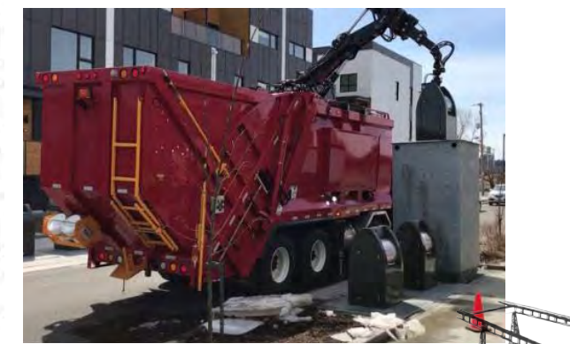
Ramassage par grue de bacs enfouis (source : Durabac)
