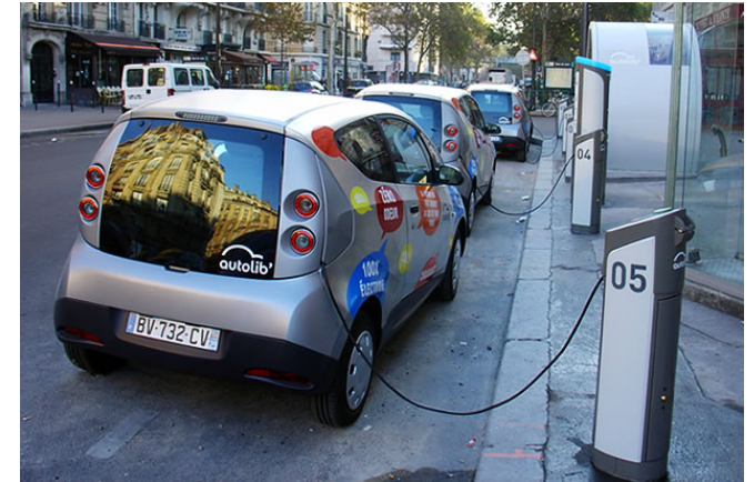
Recharge sur rue (4 bornes/station)
